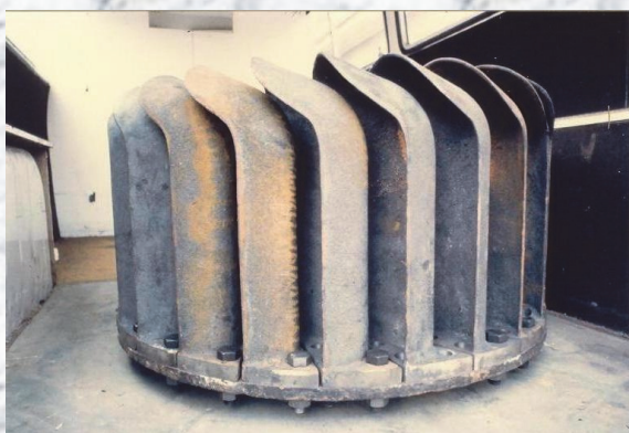
Roue de la turbine posée à l'envers, remplacement des 25 godets en 1981
