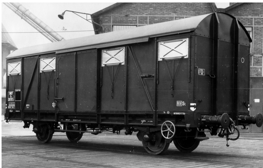
Wagon couvert standard U.I.C. à voie normale – frein à air comprimé Surface utile : 25m 2 - longueur totale : 10,58m - Poids en charge : 40 T.
