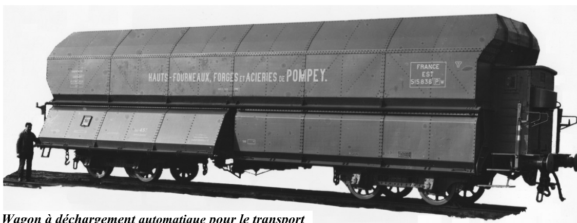
Wagon à déchargement automatique pour le transport de coke – 2 bogies type Nord-Est – Frein à air Westinghouse Tare : 24,5 T Charge : 47,5 T – Capacité : 100m 3 – Longueur totale : 15m
