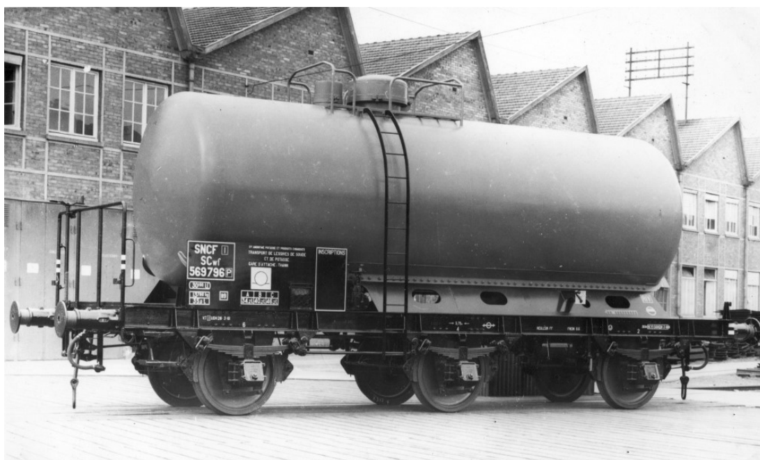
Wagon citerne à 3 essieux pour le transport de lessive de soude Capacité : 30.000 litres
