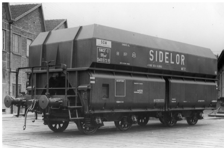
Wagon à déchargement automatique pour le transport de minerai. Tare : 20,7 T : Charge : 59,3 T – Longueur : 10m 2 bogies soudés monobloc.
