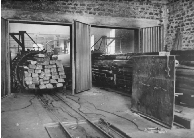
Deux autoclaves de longueur 20 mètres contenance : 6 wagonnets de 2 m 60 par autoclave.
