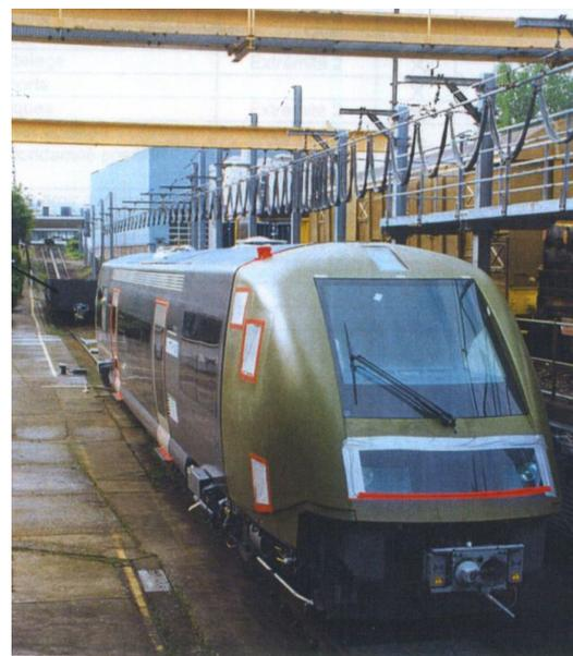
*Essai d'accostage le 15 avril 99 de l'ATER N°3 garni, percuté à la rampe de Vitry sur Seine par un wagon bouclier lesté à 50 t jusqu'à 6 km/h*
